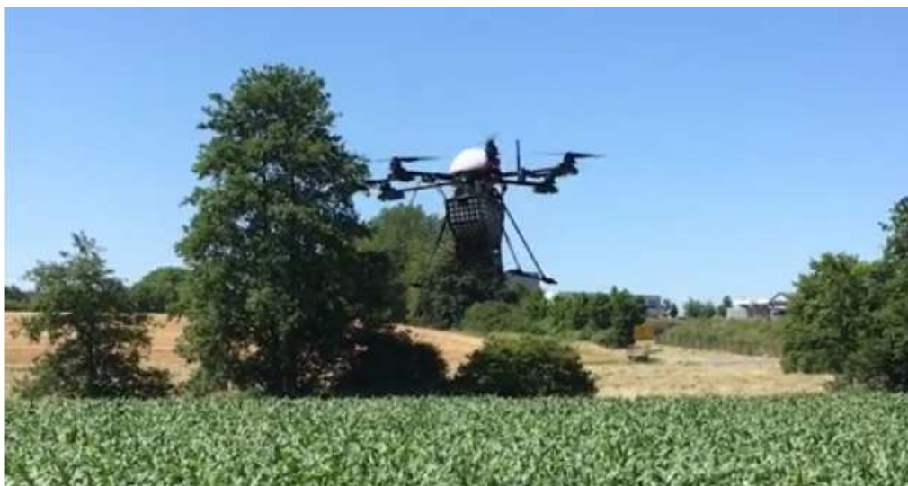
Distribuzione di Trichogramma tramite multicottero
